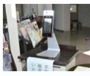
▲検温のために設置したサーモグラフィカメラ
