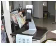
▲検温のために設置したサーモグラフィカメラ
