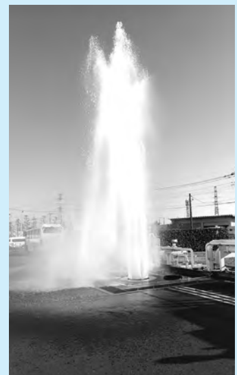
取付け構造が安全に働くかどうかを試験する装置から勢いよく出た下水を捉えたもの。
