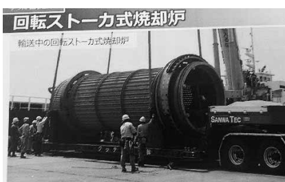
回転式ストーカ式焼却炉 輸送中の回転式ストーカ式焼却炉 運搬中のストーカ炉 (パンフレットより)
