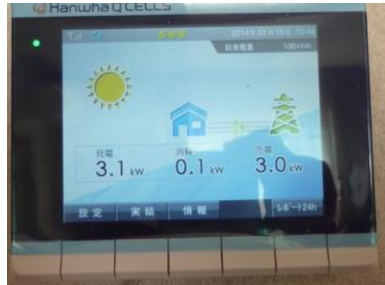
発電モニターの例
