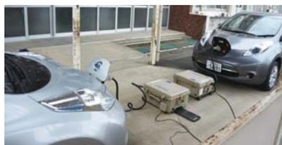
▲電気自動車から電力を供給し、避難所が停電していても電気を使えるようにします。
