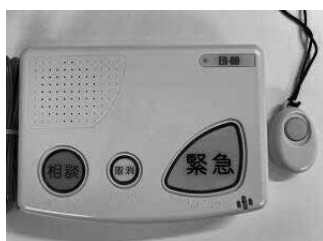
緊急時にボタン一つで救急要請や警備員が駆け付け
